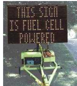
Segnaletica stradale alimentata da una cella a
