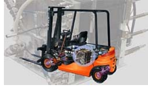
Elevatore con cella a combustibile
